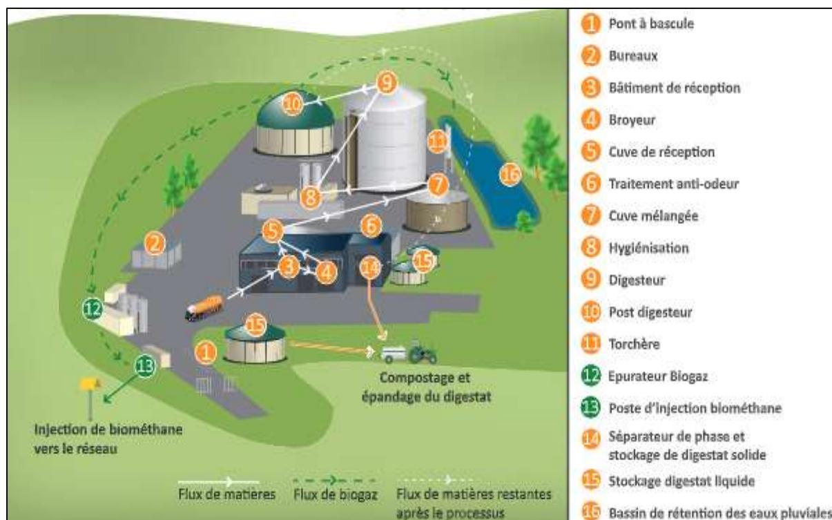
Figure 4 : Schéma de principe de l'unité BioDéac
